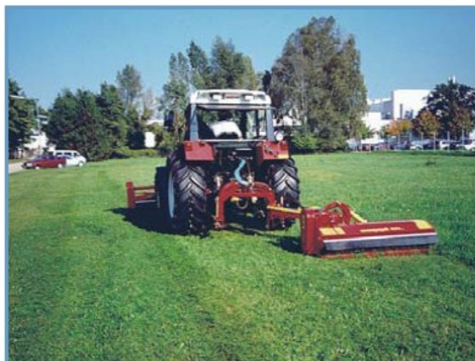
Combinatie intre un SMO-fh si SMWA-avs, latime totala de lucru 4,5 m
