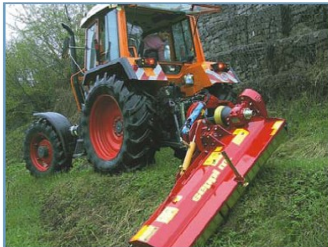
Montare optionala pentru SMWA-avs la PTO frontal (reverse drive)
